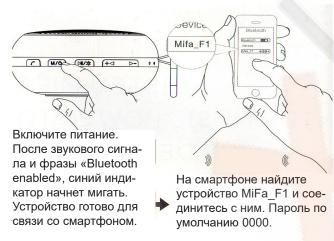
В дальнейшем колонка сама будет соединяться со знакомыми устройствами. Чтобы отвязать колонку от устройства, долго нажмите кнопку Старт/Стоп. И лишь потом соединяйтесь с другим устройством.
